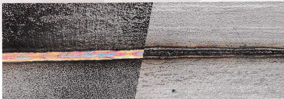
Svar na tupu - materiál nerez 3 mm / kořen
